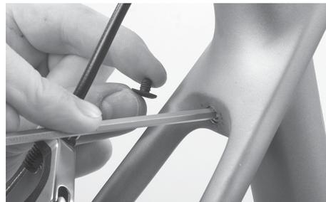
Nehmen Sie die Schutzkappe bzw. den Gummistopfen hinten vom Sattelrohr im Bereich, in dem die Streben auf das Rohr treffen. Öffnen Sie die Schraube an der Sattelrohrklemmung zwei bis maximal drei Umdrehungen. Sie müssen die Schraube nicht ganz herausdrehen, zudem zerfällt sonst der Mechanismus in seine Einzelteile.
