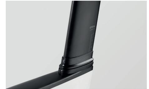
Einige Canyon Rennräder sind mit einer Aero-Sattelstütze (aerodynamische Form) mit integrierter Klemmung ausgestattet z.B. das Modell Aeroad.
