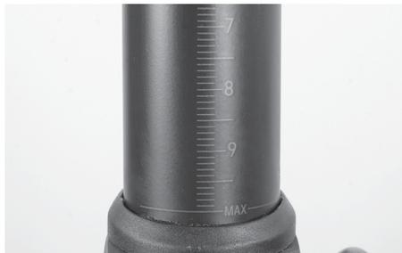
Schieben Sie die Sattelstütze bis zur benötigten Sitzhöhe in das Sattelrohr ein. Ihre Sattelstütze muss mindestens bis unterhalb des Oberrohres bzw. bis zur MAX-Markierung der Stütze im Rahmen stecken.
