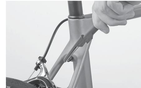
Kontrollieren Sie den festen Sitz der Sattelstütze im Rahmen indem Sie den Sattel vorne und hinten packen und versuchen diesen zu verdrehen. Drücken Sie den Gummistopfen wieder in den Kopf der Innensechskantschraube im Sitzrohr.
