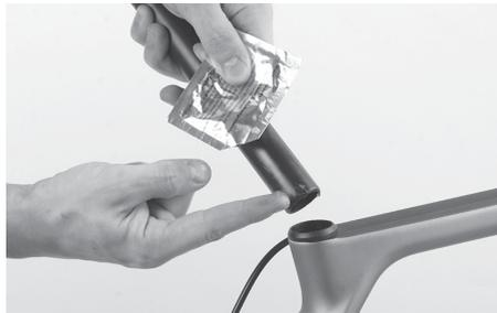
Ziehen Sie die Sattelstütze nochmals heraus. Verteilen Sie nun etwas Canyon Montagepaste auf dem unteren Teil der Sattelstütze und innen am Sitzrohr des Rahmens bzw. auf dem Klemmbereich der Sattelstütze.
