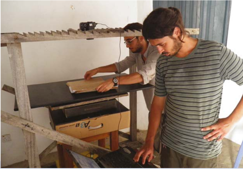
الشكل ٢٢: إيجاد حل عند تعطل حامل النسخ: EAP٥٦٩، استخدام نول النسيج لرقمنة مواد نزيما الثقافية من غانا. الصورة © ساميول نوبه، CC BY 4.0.
