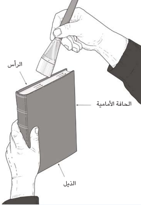
شكل ٣٢. رسم يوضح اتجاه استخدام الفرشاة الصحيح على كتاب مجلد. © رسم توضيحي آن ليفر، CC BY 4.0.
