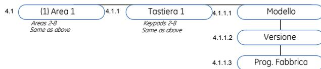
Per programmare le Altre tastiere, selezionare nel *Menu installatore* > *Altre Tastiere* e scegliere l'area a cui appartiene la tastiera. In questo menù è possibile controllare la versione e il modello della tastiera inoltre è possibile eseguire la programmazione di fabbrica della stessa.
